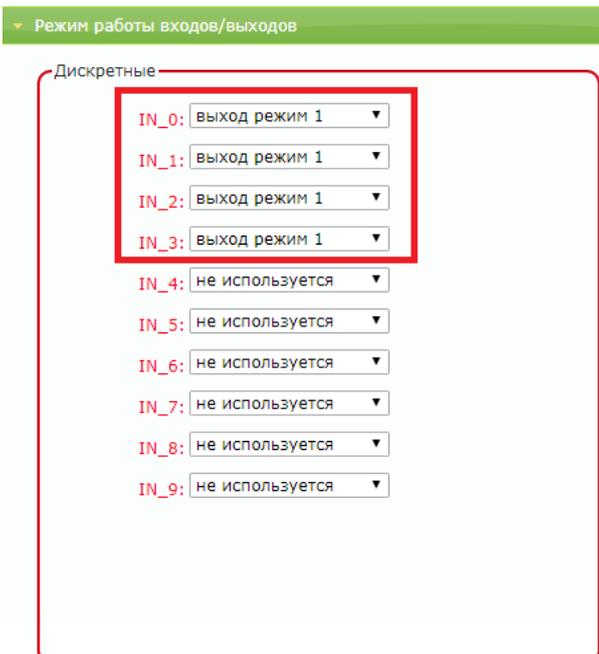
**Режим «выход режим 1»** – режим работы, в котором выход активируется и деактивируется вручную. Состояние выхода сохраняется в энергонезависимую память и восстанавливается после перезапуска устройства. Выход принудительно деактивируется при смене режима работы.
