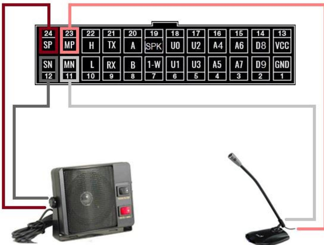
Рисунок 9 – Схема подключения микрофона и динамика
