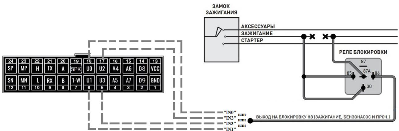
Рисунок 4 – Пример подключения реле блокировки двигателя
