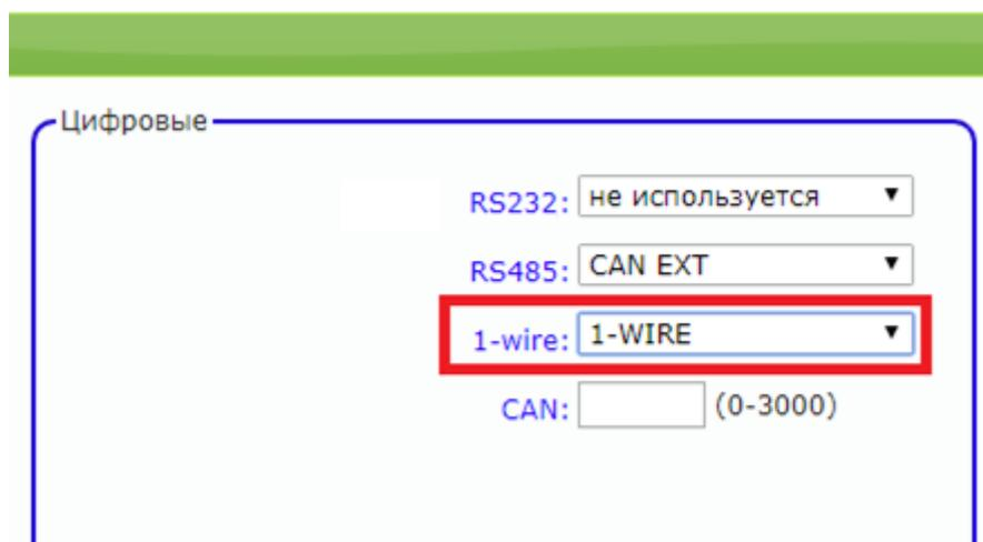
Для контроля температуры различных устройств или объектов используются датчики температуры, работающие по интерфейсу 1-wire (на одной шине данных может быть подключено до 8 датчиков одновременно). Так же, параллельно с термодатчиками есть возможность подключить разъем для считывания ключей i-button.
