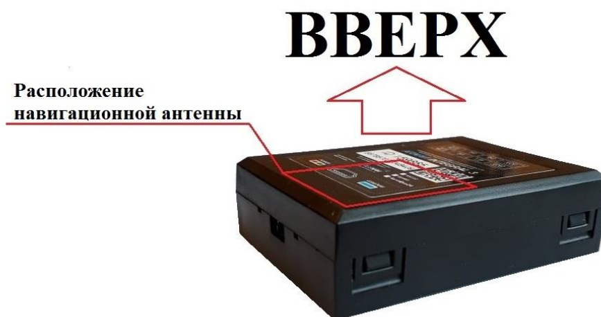
Рисунок 4 – Положение устройства при установке
