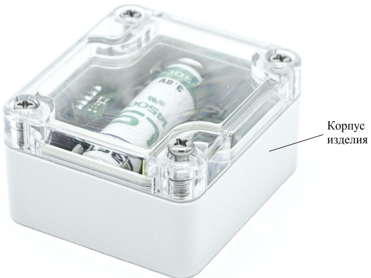
Рис.3.4. Конструкция беспроводного датчика температуры и освещенности TL-BLE
