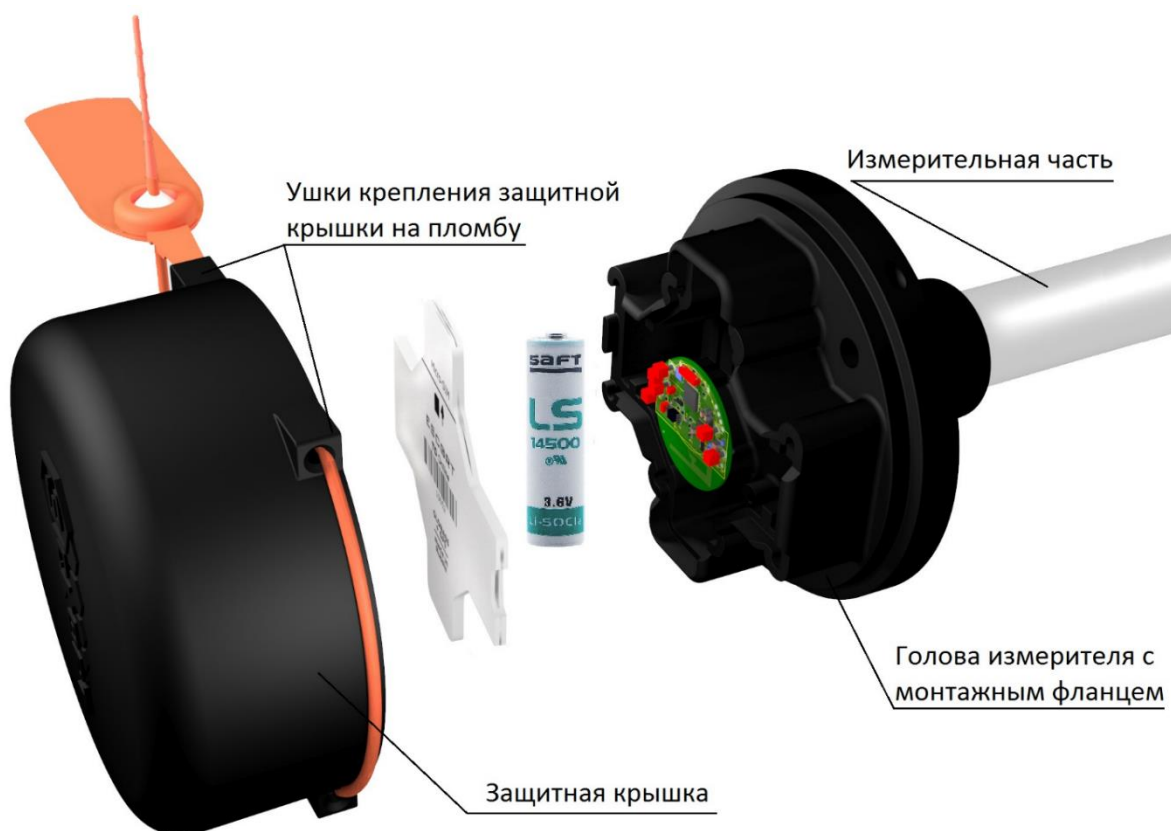
Рис. 3.1. Конструкция емкостного измерителя уровня топлива TD-BLE
