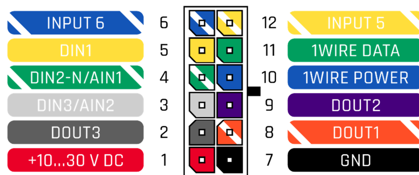
Рисунок 1 FMC130 2x6 распиновка розетки
