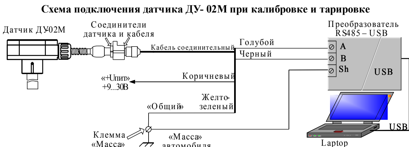
Рис. 1. Схема подключения датчика ДУ-02М при калибровке и тарировке
