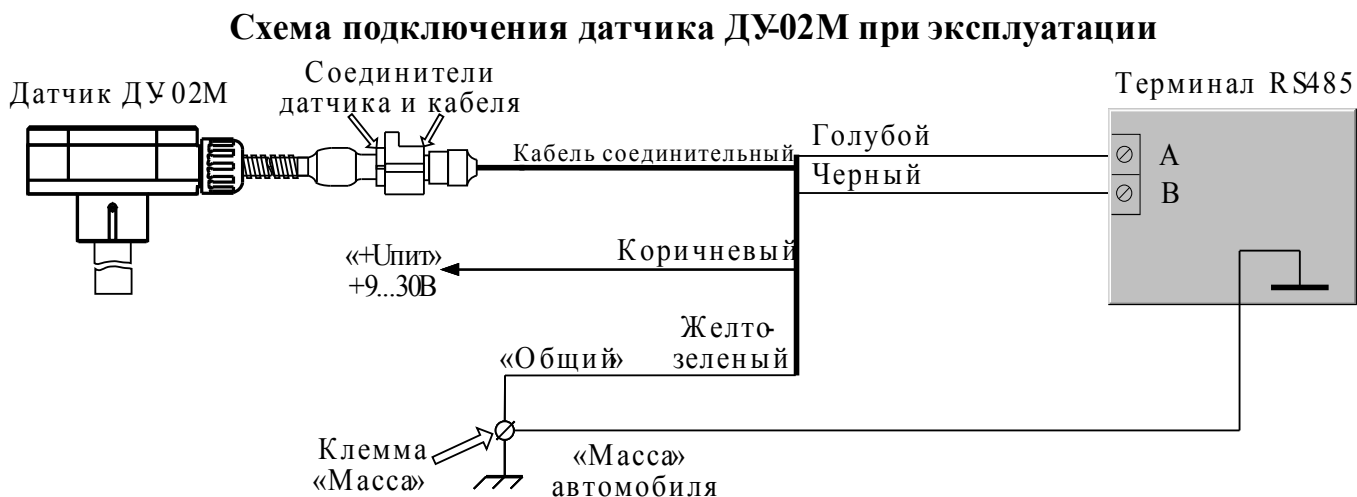
Рис.19 Схема подключения датчика ДУ-02М при эксплуатации
