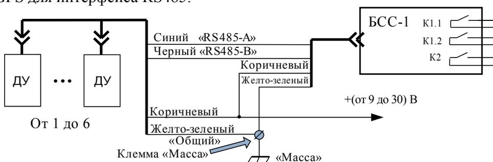
Рис. Б-2. Схема подключения ДУ02, ДУ02S4 и БСС-2 при работе в конфигурации без терминала GPS для интерфейса RS485.
