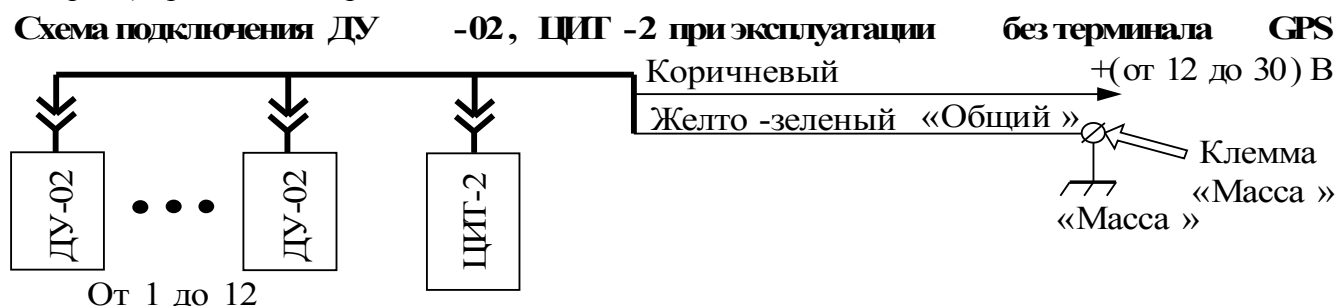
Рис. 3. Схема подключения ДУ-02, ЦИТ-2 при эксплуатации без терминала GPS.
